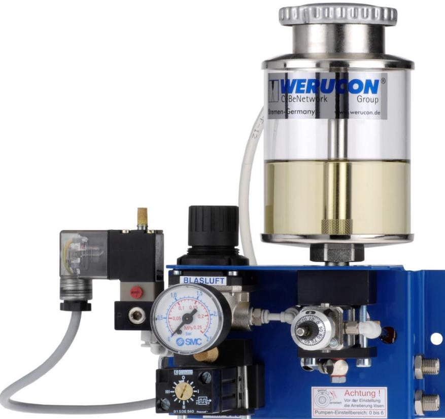
Une technologie de micro-pompes efficace pour l'application des différents lubrifiants industriels, avec utilisation de buses pour un spectre grand, fin, detaille modifiable.
