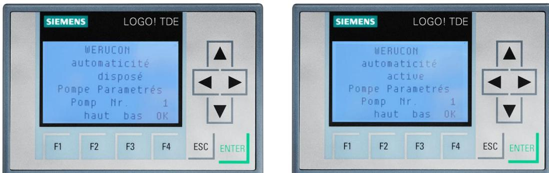
Si l'appareil est prêt pour le processus automatique, l'écran affiche « ready ». Si lorsque le mode automatique est activé et que la commande en amont présente le signal initial à 24 V, la description à l'écran passe de « ready » à « active » et le dosage commence avec les buses activées (3.2 – 3.7).
