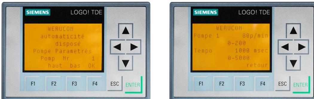
Les touches de fonction *F2* et *F3* permettent de parcourir la liste de sélection vers le haut ou le bas (pompe de dosage 1-6). La touche de fonction *F4* permet d'accéder à la fenêtre de configuration de chaque pompe de dosage.
